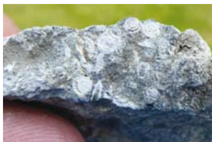
Nummulietenkalksteen uit de witte hoeksteen van de Pijntoren
