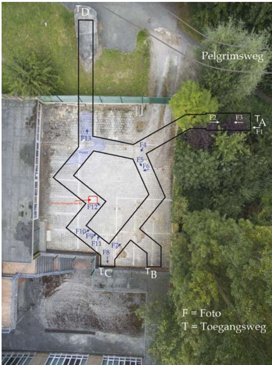
Luchtopname van het parkeerterrein met de schets van de ondergrondse constructie in superpositie (Opname met drone, najaar 2016)
