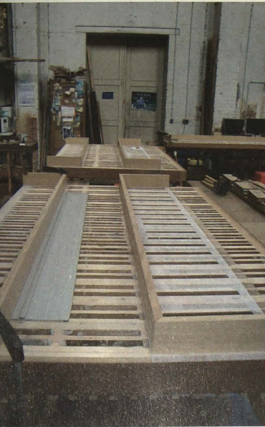
Zicht op het atelier Westenfelder waar de nieuwe kleppenkasten gemaakt worden voor de windladen van het Anneessensorgel.
