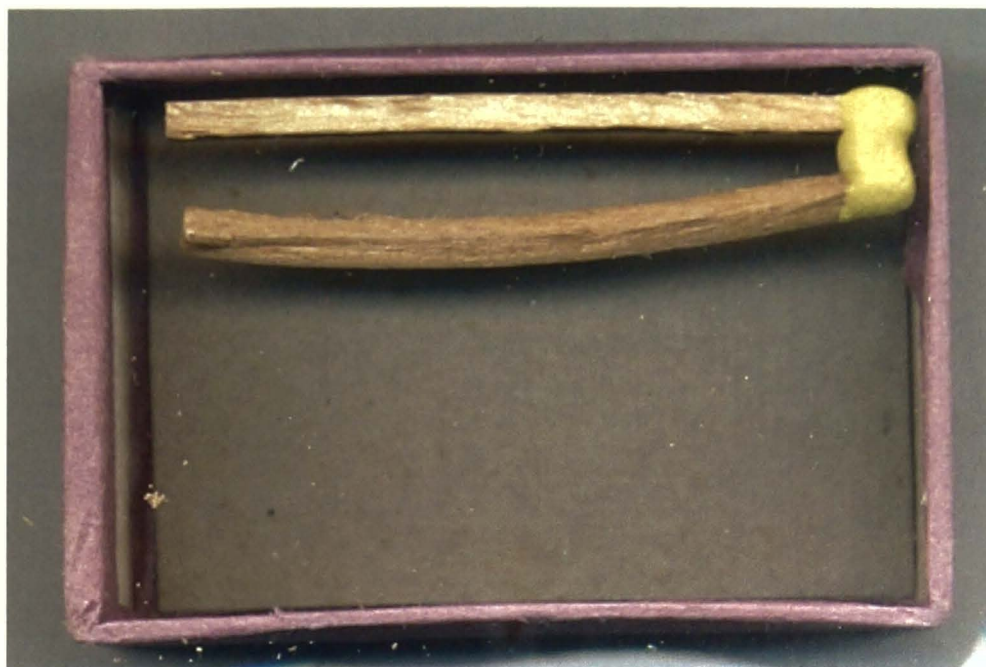
Authentiek resultaat van één van de talrijke laboproeven van Carlos Roland. Om de luciferskoppen een grotere weerstand tegen vochtigheid te geven, ontwikkelde en verfijnde hij verscheidene soorten vernis. Hierbij was het belangrijk dat het vernis een snelle opdroogtijd had waardoor de luciferskoppen in de doosjes achteraf niet aan elkaar zouden vastplakken. Op de foto een voorbeeld van een niet-geslaagd resultaat.
